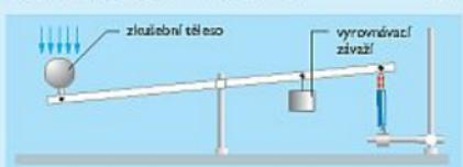
Pomocí aerodynamických vah se zjišťuje odporové a vztlačkové síly zkušebních těles. Odpor kotouče se stanoví takto:  $c_v = 1$ . Součinitelé odporu jiných zkušebních těles se udávají v poměru ke kotouči. Přitom jsou rychlosť proudění, průřez tělesa a vlastnosti povrchu u všech tvarů těles stejně.
