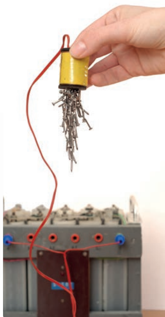
Malý elektromagnet z relé
